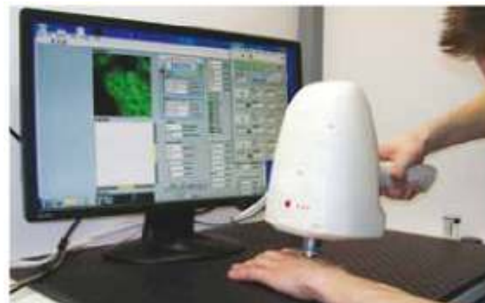
FiberScope, a kézben tartott nemlineáris mikroszkóp
