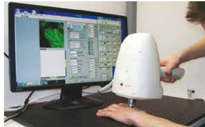
FiberScope, a kézben tartott nemlineáris mikroszkóp
